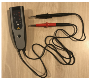
Vérificateur d'absence de tension (VAT)
